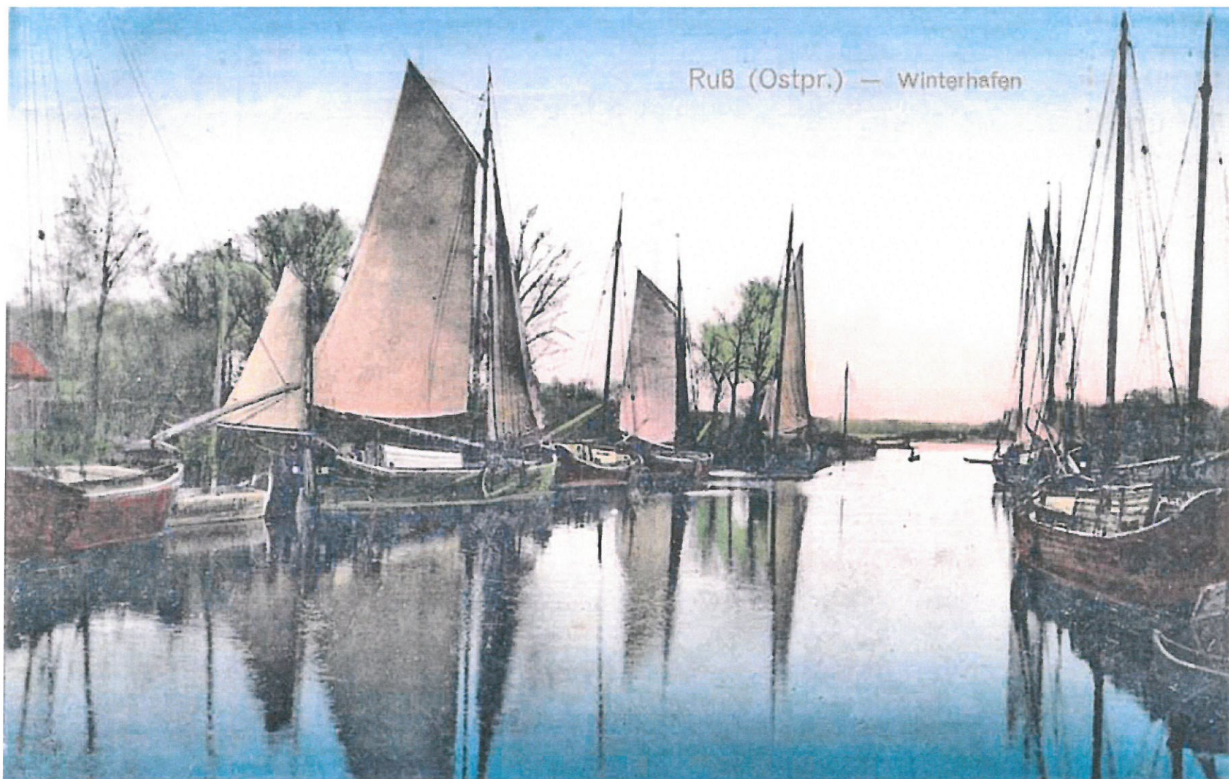
XX a. pr. Rusnės atvirukas, kuriame vaizduojamas Rusnės Žiemos uostas. Visa Pakalnės pakrantė aukščiau tilto iki Skirvytės užstatyta žiemojimui ruošiamais burlaiviais. Rusniškiai laivininkai buvo įvaldę upių transporto verslą, iš kurio pelnas buvo daug didesnis nei iš žvejybos. Šie burlaiviai gabendavo iki 180 tonų krovinį. Tai lietuviškos vytinės: mažosios (vienstiebės) ir didžiosios (dvistiebės). Atviruko kopija iš AdM archyvo
